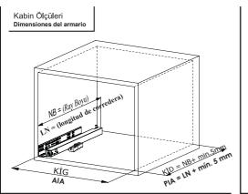
Ancho interior del armario : AIA Kabin İç Genişliği : KİG Profundidad interior del armario : PIA Kabin İç Derinliği : KİD Profundidad del cajón : PC Çekmece Derinliği : ÇD : CIG Ancho interior del cajón : AIC Çekmece İç Genişliği Nominal Boy (Ray boyu): NB Longitud nominal : LN
