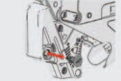
3 Coloque el pasador de seguridad del amortiguador.
