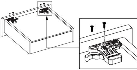
**Примечание:** При выбранной ширине дна менее 12 мм используйте наклонные отверстия для монтажа интеллектуального механизма закрывания.
