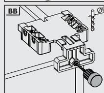
Разметка отверстий для Pin-Fix
