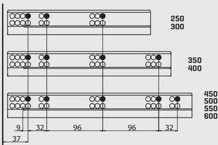
Зафиксируйте направляющую со стороны отмеченных отверстий.
