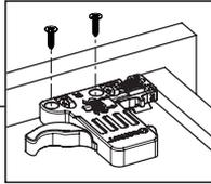
**Nota:** Use los orificios angulados para fijar el gancho cuando el espesor del fondo del cajón sea menor de 12 mm.
